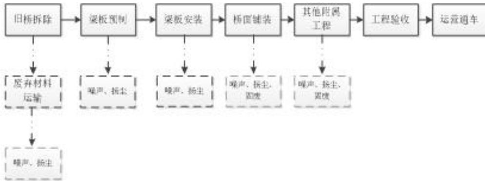
图4-2 桥梁改造施工期施工工艺流程图
