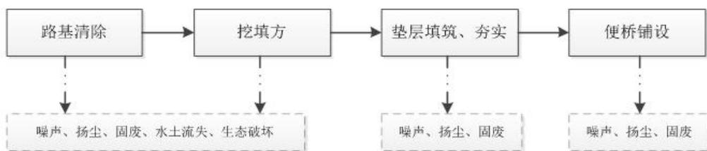
图 4-1 便道施工期施工工艺流程图
