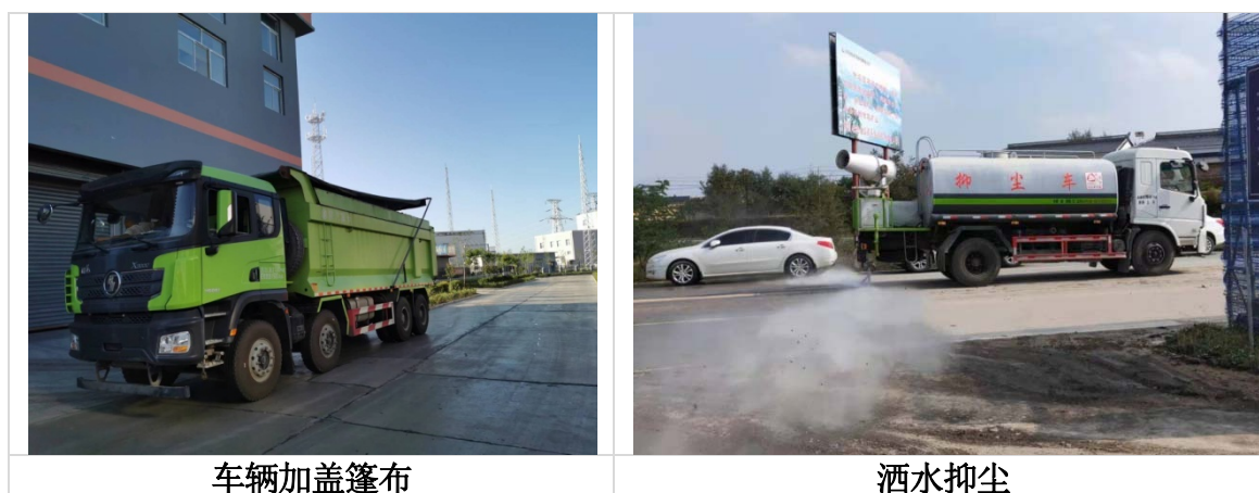
图 5.2.3-3 道路扬尘治理措施
